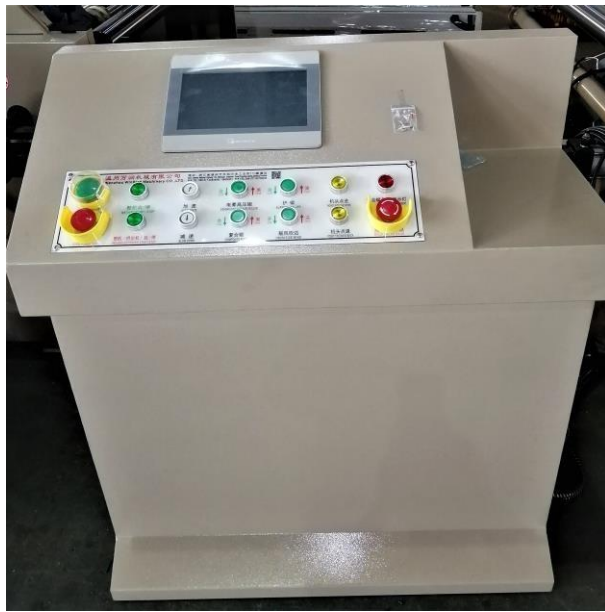
PLC kontrolü; Dokunmatik ekran kullanımı
